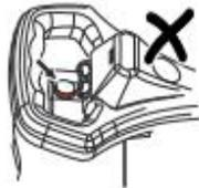
Der Fahrradträger ist nicht korrekt auf der Anhängerkupplung verriegelt, wenn die runde Sicherheitsanzeige sichtbar ist und rot zeigt.
